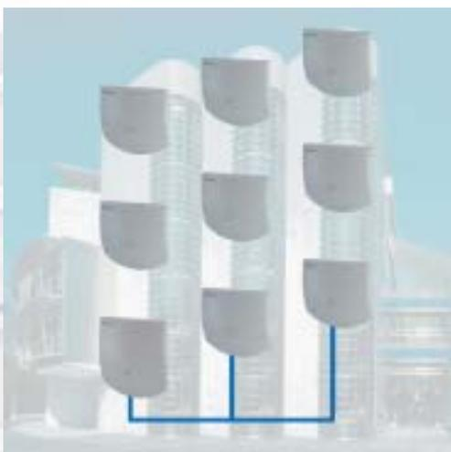
**Große Anlagen** werden im "Baukastenprinzip" mit den gleichen Komponenten ausgerüstet. Es werden Teilnetzwerke errichtet, die mittels M-Bus an einem Siemeca™ Gateway zusammengeführt werden. Dort können dann auch weitere M-Bus Geräte integriert werden. Die Auslesung erfolgt genauso wie bei allen anderen Anlagen auch - ganz nach Ihren Anforderungen.
